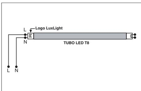
Esquema montaje con balasto magnético.
