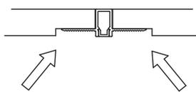
Introducir el perfil en el techo o pared, marcar las solapas y hacer un rehundido de 3mm para nivelar las solapas al panel.
