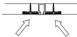
Colocar cinta de junta y masillar las solapas para integrar la luminaria.
