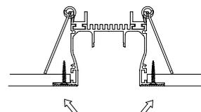
Colocar cinta de junta y masillar las solapas para integrar la luminaria.
