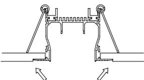
Introducir luminaria en el techo o pared, marcar las solapas y hacer un rehundido de 3mm para nivelar las solapas al panel.
