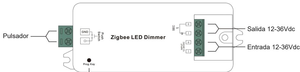
Tecla de programa: Pulse para encender / apagar el dispositivo, presione y mantenga presionado para aumentar / disminuir la intensidad de la luz.
