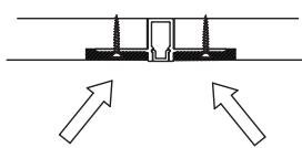
Colocar cinta de junta y masillar las solapas para integrar la luminaria.
