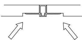
Introducir el perfil en el techo o pared, marcar las solapas y hacer un rehundido de 3mm para nivelar las solapas al panel.
